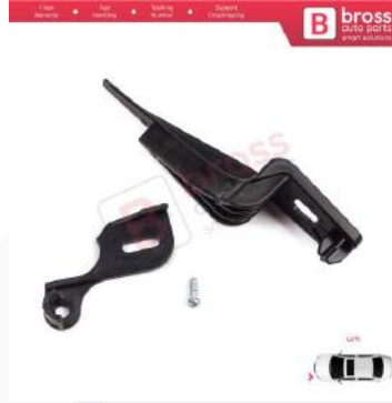
BHL43 Ford Fiesta MK6 CB1 CCN B299 B409 2008-2013 8A6113W030 İçin Sol Ön Far Ayak Tamir Seti
