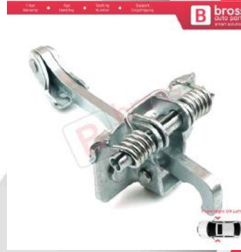
BDP726 Opel Vivaro Primastar Trafic MK2 İçin Ön Kapı Gergi Yayı 4408993
